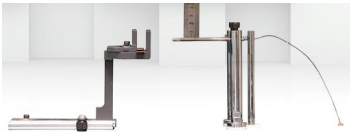
用于评估不同树脂的灼热丝测试装置
