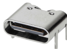
USB 2.0 Type-C 插座，顶部安装， 6 电路 (217175 系列)
