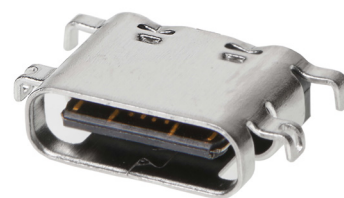
USB 2.0 Type-C 插座，中置安装， 16 电路 (216990 系列)
