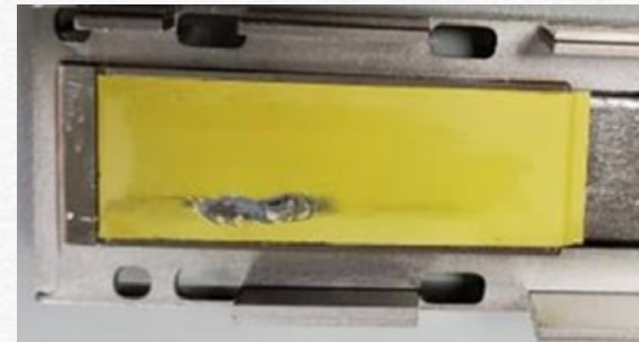
ケージ / ヒートシンク上のサーマルパッドの損傷
