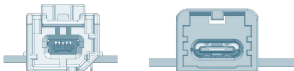
5ピン USCAR 30 コネクタと、24ピン HSAutoLink C コネクタの比較 (ヘッダーデザインは参照用)
